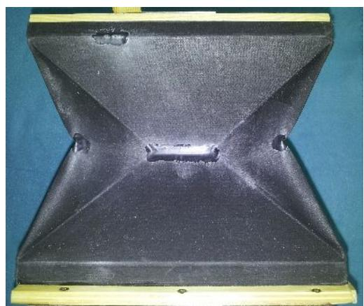
Ursachen: Kleine Verletzungen durch Werkzeuge bei Bau, Reiben der Balgbespannung beim Ausprobieren, unübersichtliche Klebungen an den Scharnieren, Reiben an den Steuerschlüchen (s.u.) usw.
