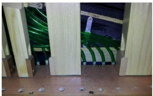
Abhilfe Die Pfeife 3 muss um etwa 1 cm auf dem Pfeifenstock nach rechts versetzt und um 90° gedreht eingesetzt werden. Dafür wird die Windlade an der Dichtung auseinander geschraubt. Um das Loch von Pfeife 3 herum wird ein rechteckiges Teil der oberen 4 mm Platte mit einem Stechbeitel herausgearbeitet und ein passend zugeschnittenes Teil eingelegt. Nach dem Glätten der Oberfläche wird die neue Bohrung angebracht, die nun etwas versetzt auf die Bohrung des Ventilsockels
